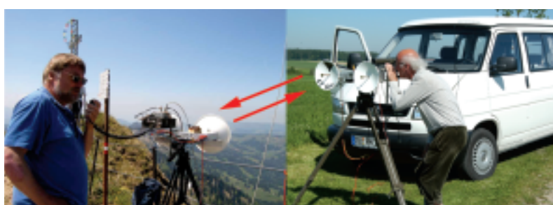
Bild 6: Nach dem Selbstbau folgt der Transvertertest in freier Natur. Wilfried Werkmeister, DH9YAU (L), funkte in SSB auf 76 GHz über eine Distanz von 64 km mit DL2AM (r.)
