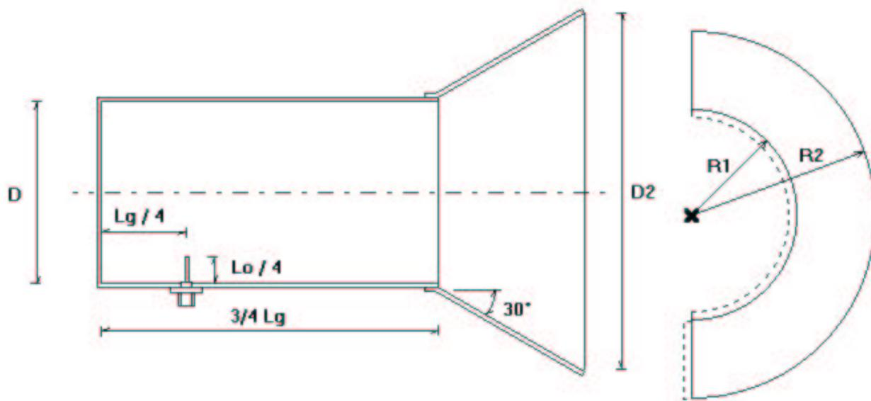
La imagen de la derecha muestra cómo debe cortarse la hojalata para hacer el embudo. Las líneas de puntos muestran los márgenes necesarios para las juntas. Esta antena la hice a partir de una pieza de conducto de aire acondicionado, con un diámetro  $D = 100$  mm, al que añadí un fondo de hojalata. Las dimensiones de la antena son, por lo tanto:  $D = R1 = 100$  mm,  $D2 = R2 = 170$  mm,  $Lg/4 = 44$  mm,  $Lo/4 = 31$  mm,  $3/4 Lg = 132$  mm
